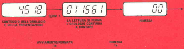
Fig. 2 - Modi di funzionamento del cronometro: (a) normale; (b) sequenziale; (c) a suddivisione.
